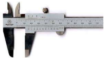
شکل (1-8) خط کش، متر فیته‌بی و ورنیرکالیپر را نشان می‌دهد
