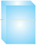
شکل (7-1) عبور نور از شیشه به صورت عمودی
