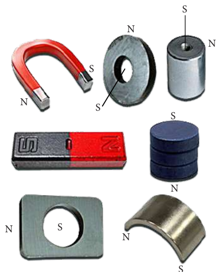
شکل (2-3) اشکال مختلف قطب‌های آهن‌رباها
