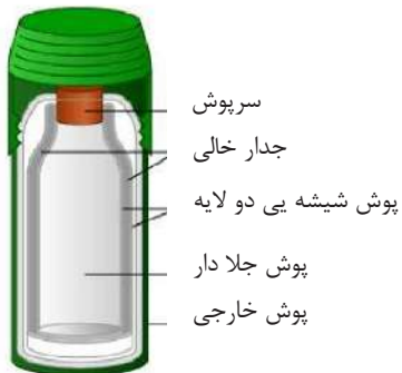
شکل (۱۳-۲) ب، ساختمان ترموز
